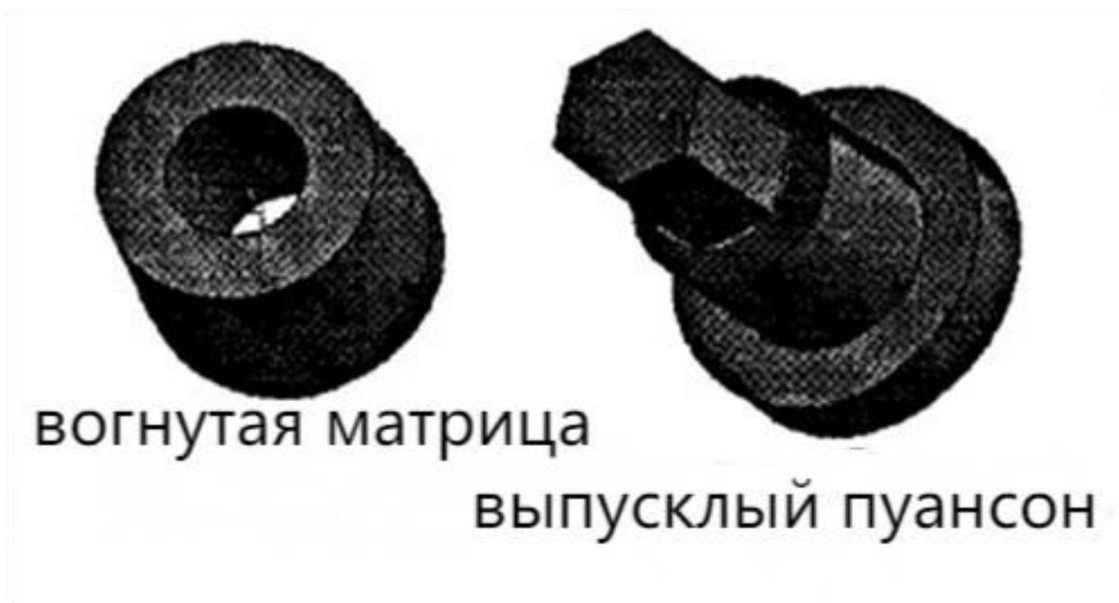
Рисунок 2 – матрица 3D-модели (слева) пуансон 3D-модели(справа)
