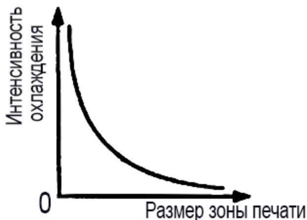
Рисунок 2 – График зависимости интенсивности охлаждения от размера зоны печати.
