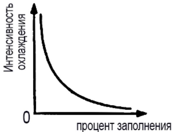
Рисунок 3 – График зависимости интенсивности охлаждения от процента заполнения
