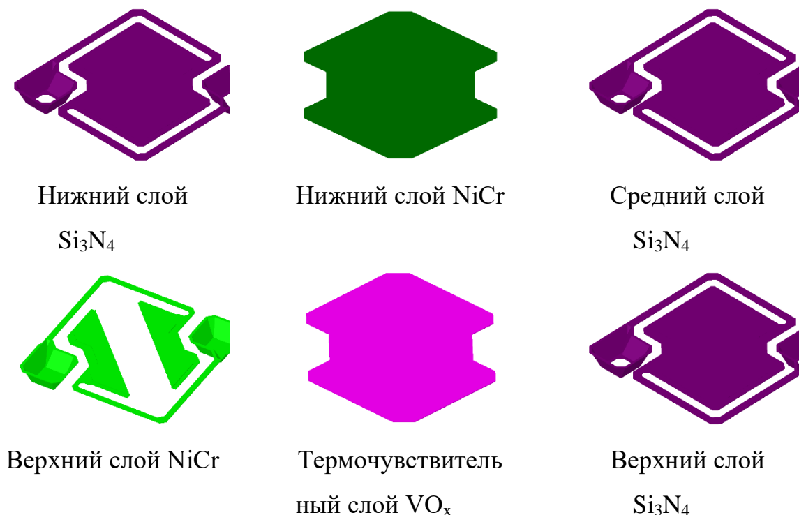
Рисунок 1. Конструктивные слои микроболометра.
