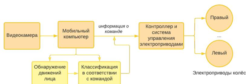
Рисунок 2. Блок-схема интеллектуальной системы управления креслом-коляской жестами головы на основе компьютерного зрения.
