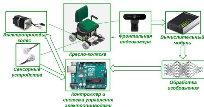
Рисунок 1. Блок-схема интеллектуальной системы отслеживания движений глаз в кресле-коляске.
