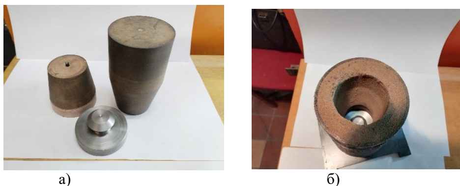
Рисунок 1 - Технологическая оснастка (а) и форма в сборе (б) для получения образцов катода-мишени методом литья
