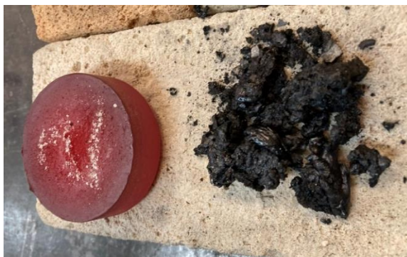
Рисунок 7 – Слиток, полученный с применением брикетов в составе шихты, и шлак
