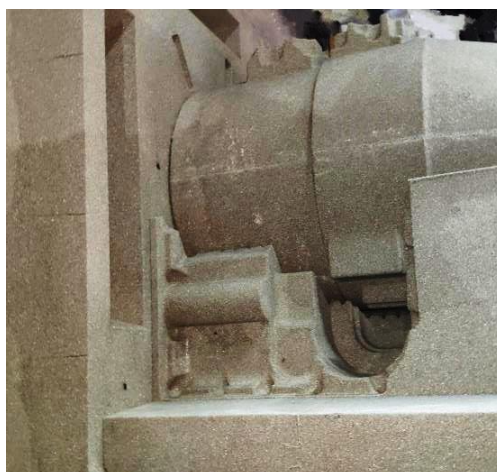
Рисунок 1 - Форма из ХТС (а) и полученные отливки из алюминиевых сплавов (б).
