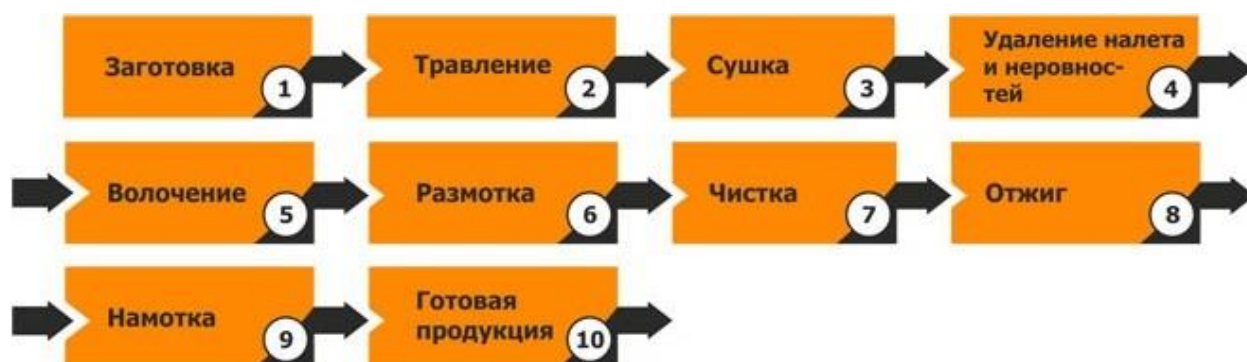
Рисунок 2 – Технологическая схема волочения проволоки из нержавеющей стали Изготовление проволоки по технологии волочения включает в себя несколько этапов:
