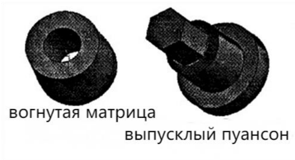
Рисунок 2 – матрица 3D-модели (слева) пуансон 3D-модели(справа)
