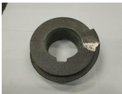
Рисунок 8 – Опытная отливка «шнек», изготовленная с использованием одной прибыли
