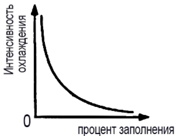
Рисунок 3 – График зависимости интенсивности охлаждения от процента заполнения
