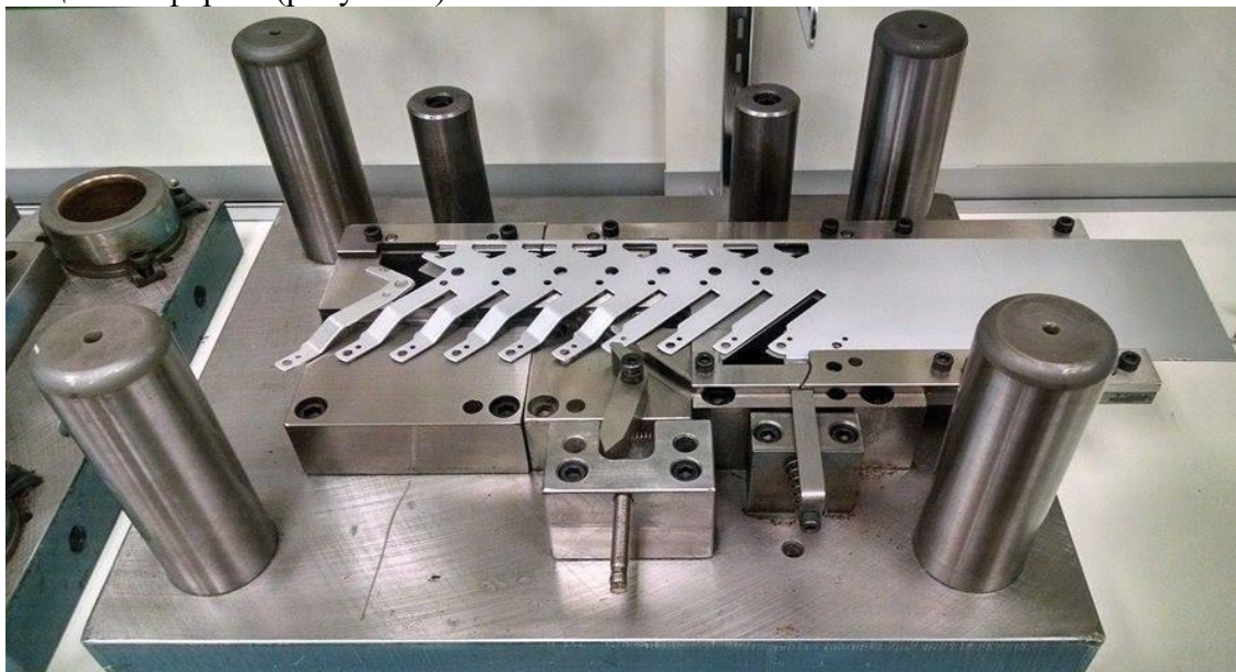
Рисунок 2 – Процесс прецизионной листовой штамповки
