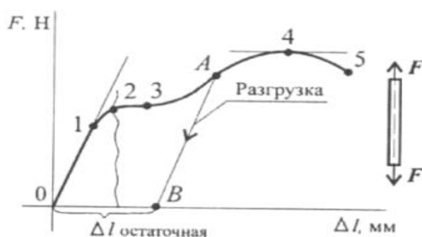
Рисунок 4 – График зависимости между приложенной силой и деформацией при растяжении
