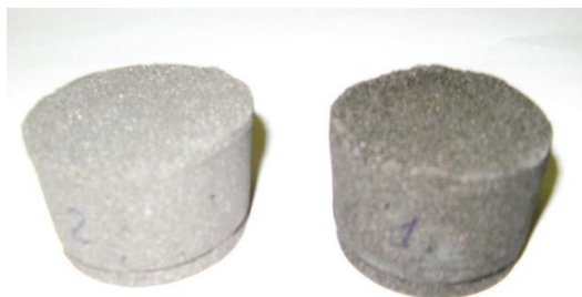
Рисунок 3 – Внешний вид брикетов из пылевидных отходов, полученных в результате отсева при производстве литой дробы, где в качестве связующего использовали натриевое жидкое стекло
