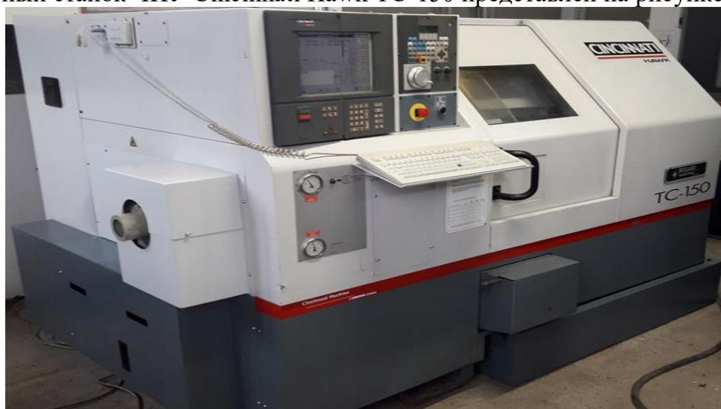
Рисунок 2 – Токарный станок ЧПУ Cincinnati Hawk TC-150
