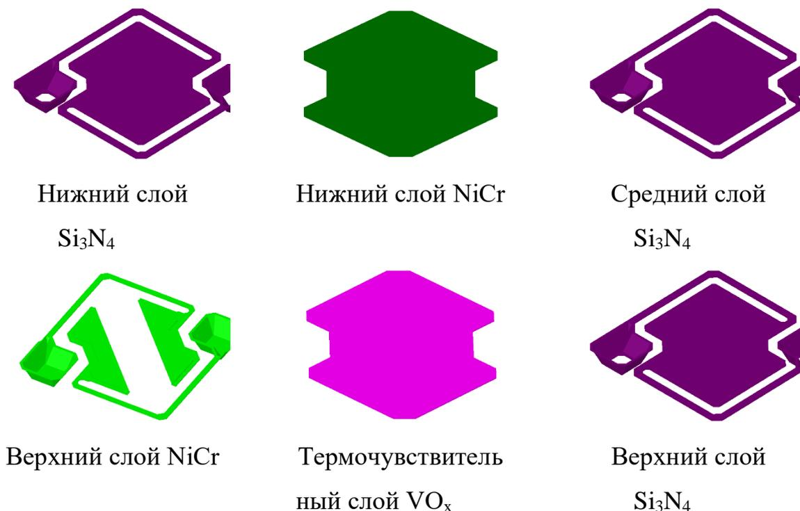
Рисунок 1. Конструктивные слои микроболометра.
