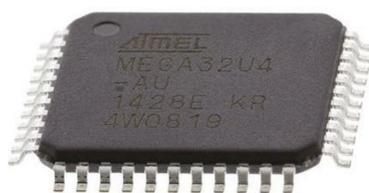
Рисунок 1 – Микроконтроллер ATmega32U4-AU
