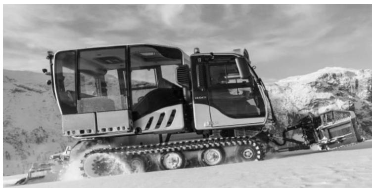
Рис. 1. Ратрак с установленной кабиной для перевозки людей
