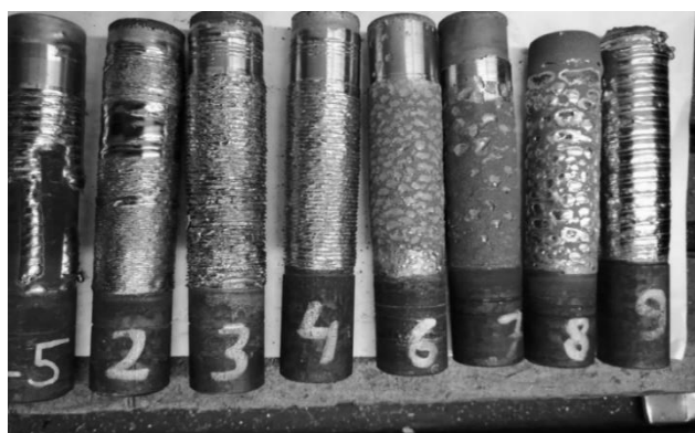
Рис. 4. Общий вид образцов после оплавления на первоначальном этапе
