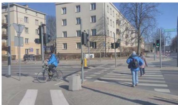
Рис. 3. Организация наземного регулируемого пешеходного перехода с выделенной полосой велодвижения в г. Белосток
