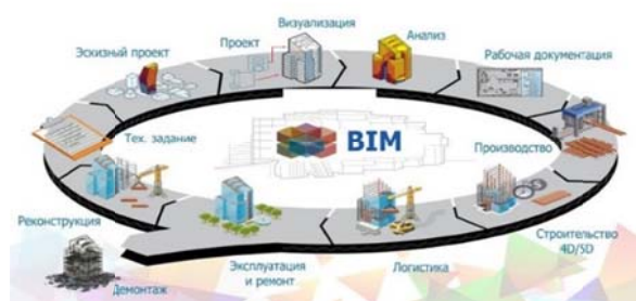
Рис. 4. Жизненный цикл сооружения
