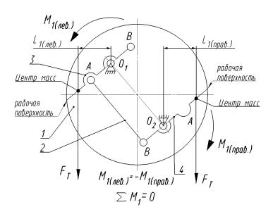
Рис. 3. Баланс сил тяжести противоположно направленных рабочих органов при их нерабочем положении (пружина не показана):
