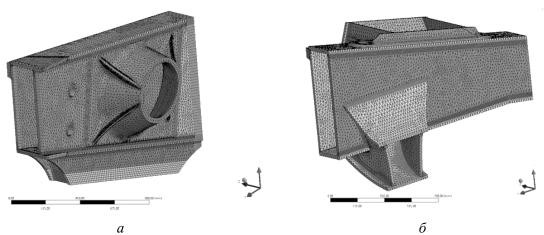
Рис. 9. Конечно-элементные подмодели исследуемых фрагментов конструкции рамы: a — первая подмодель;  $\delta$  — вторая подмодель
