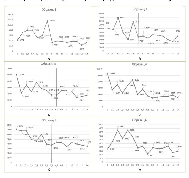
Рис. 6. Графики изменения твердости по глубине: a-e – режимы 1–6
