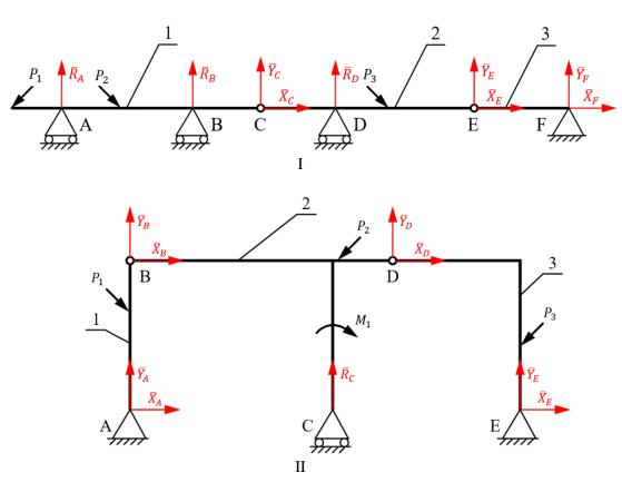
Рис. 7. Трехэлементные схемы: I – «Мост»; II – «Ферма»
