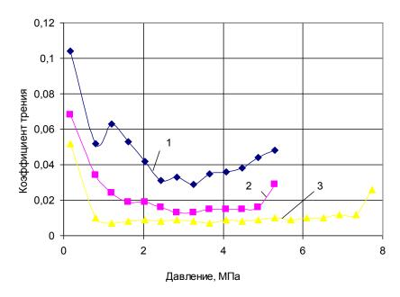
Рис. 1. Влияние давления на коэффициент трения антифрикционных материалов на основе железа:
