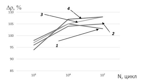
Рис. 2. Влияние частоты нагружения на изменение плотности дислокаций стали 25ХГТ, прошедших поверхностное упрочнение  $(1-0.3 \text{ к}\Gamma\text{ц}; 2-3.0 \text{ к}\Gamma\text{ц}; 3-9.0 \text{ к}\Gamma\text{ц}; 4-18.0 \text{ к}\Gamma\text{ц})$
