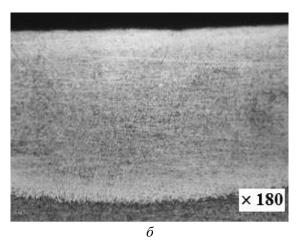
Рис. 3. Микроструктура стали 45 при термообработке в среде аргона: a – зона влияния плазменной струи;  $\delta$  – микроструктура зоны нагрева
