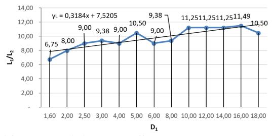
Рис. 4. Отношение длин обработки ступенями КОИ от диаметра отверстия  $D_I$  с поднутрением (линия тренда на графике:  $y_L = \frac{L_1}{L_2}$ ,  $x = D_1$ )
