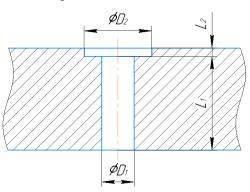
Рис. 2. Типовая схема крепежного отверстия с поднутрением
