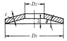
Рис. 1. Тарельчатая пружина
