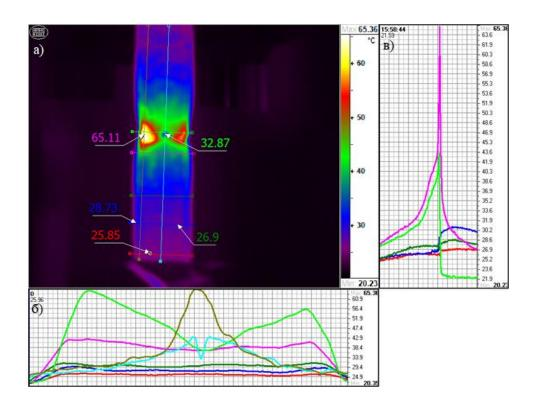
Рис. 4. Термограмма (кадр 132) деформирования образца 2 при образования шейки (a) и графики изменения температур поверхности по выделенным линиям (b) и точкам за время испытания образца (b)
