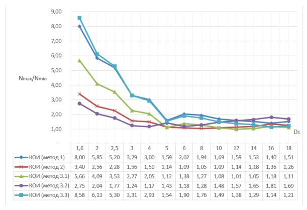
Рис. 8. Относительная штучная наработка до отказа  $N_{max}/N_{min}$  КОИ в зависимости от диаметра  $D_I$  обрабатываемого отверстия при различных стратегиях назначения режимов резания
