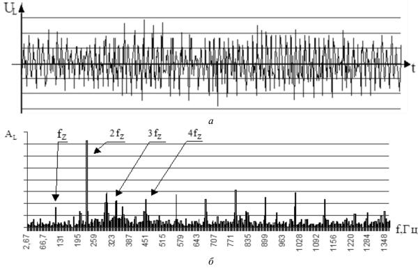
Рис. 1. Временная (a) и амплитудно-частотная (b) характеристики колебаний пары зубчатых колес
