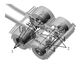
Рис. 2. Общий вид модели задней подвески в программе ADAMS: 1 – пневмобаллоны заднего моста; 2 – пневмобаллоны задней подъемной оси
