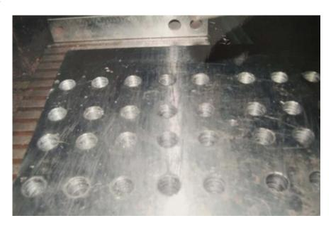
Рис. 3. Наружный вид заготовки из стали 45 на станке модели 6М13В после сверления
