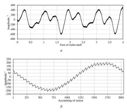
Рис. 4. Сигнал кинематической погрешности во временном базисе и при синхронном анализе в зависимости от угла поворота вала [4]
