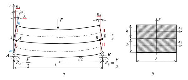
Рис. 1. Изгиб двухопорной балки, составленной из не связанных между собой стержней: a – схема нагружения и деформации балки;  $\delta$  – поперечное сечение балки
