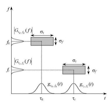
Рис. 5. Графическое отображение кратковременного Фурье-преобразования
