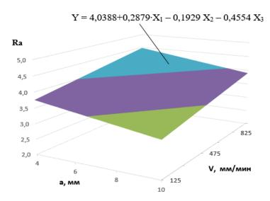
Рис. 1. Поверхность отклика влияния амплитуды и скорости на шероховатость при ширине луча  $0.5~\mathrm{mm}$
