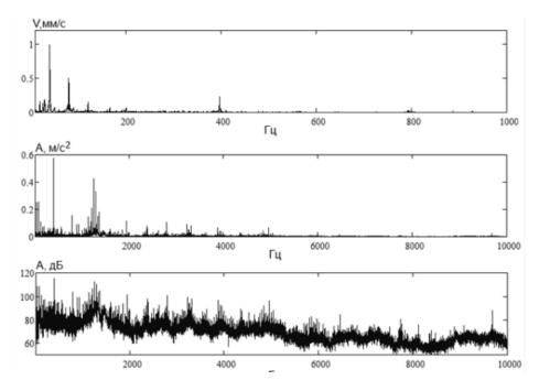
Рис. 1. Спектр виброскорости в мм/с и виброускорения в м/ $c^2$  в линейном масштабе и тот же спектр в децибелах (дБ) виброускорения
