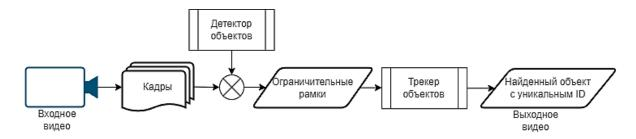
Рис. 1. Общий алгоритм визуального обнаружения и отслеживания объектов
