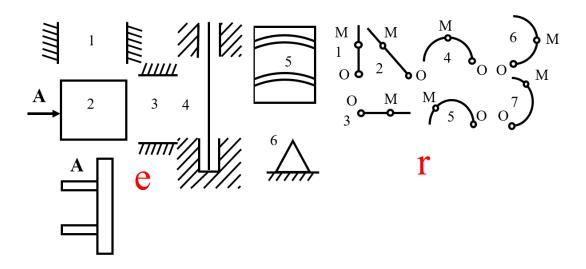
Рис. 1. Простые элементы слева — направо: переносного движения e-1–6, вид A; относительного движения r-1–7, OM
