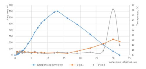
Рис. 12. Взаимосвязь максимальных температур в точках 1 и 2 с машинной диаграммой
