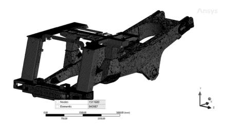
Рис. 4. Конечно-элементная модель рамы
