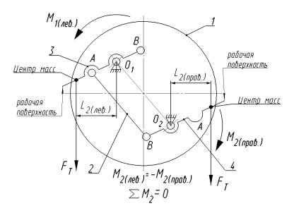
Рис. 4. Баланс сил тяжести при рабочем положении противоположно направленных рабочих органов (пружина не показана):
