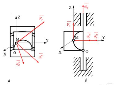
Рис. 3. Варианты схем синтеза КСДТ, построенных по критерию  $\overline{a} = \overline{a_r^n} + \overline{a_e^n}$
