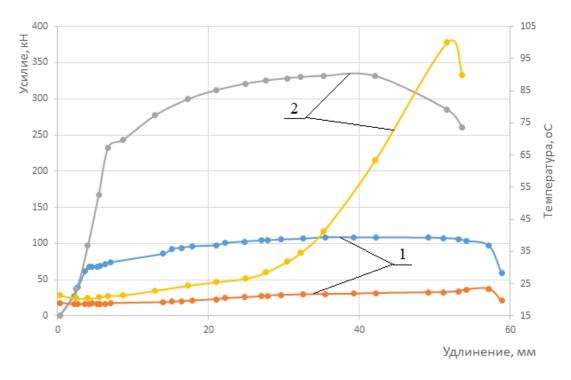
Рис. 5. Машинные диаграммы для пропорциональных образцов толщиной 8 мм (1) и 20 мм (2) и изменение соответствующих максимальных деформационных температур
