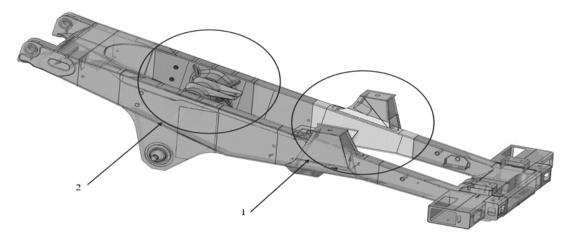
Рис. 7. Выделенные для детального анализа фрагменты конструкции рамы (подмодели): подмодели зон 1 и 2
