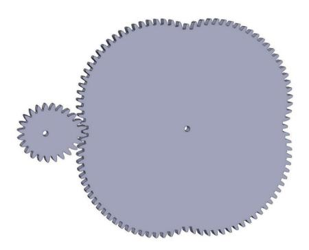
Рис. 3. Трехмерная модель зацепления некруглых зубчатых колес
