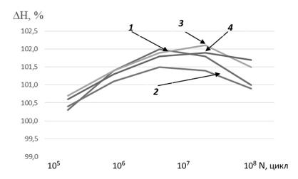
Рис. 1. Влияние частоты нагружения на изменение микротвердости стали 25ХГТ, прошедших поверхностное упрочнение (1-0.3 к $\Gamma$ ц; 2-3.0 к $\Gamma$ ц; 3-9.0 к $\Gamma$ ц; 4-18.0 к $\Gamma$ ц)
