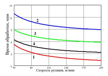
Рис. 2. Расчетное время обработки одной детали: I — время резания; 2 — время обработки универсальным инструментом; 3 — время обработки комбинированным инструментом с использованием паллет
