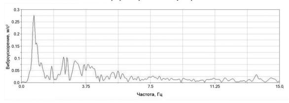
Рис. 5. График амплитудно-частотной характеристики виброускорений
