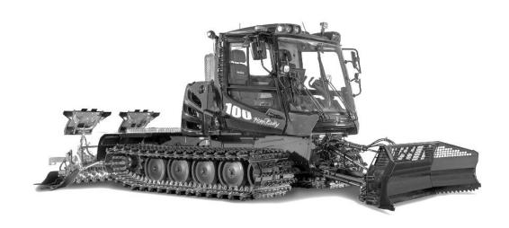
Рис. 9. PistenBully 100 с двигателем CuminsB 6.7 мощностью 188 кВт/256 л. с.
