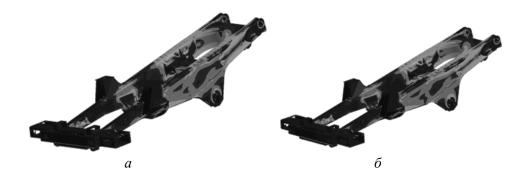
Рис. 6. Качественное сравнение накопленных повреждений в интегральном виде: a – гибкая рама;  $\delta$  – жесткая рама
