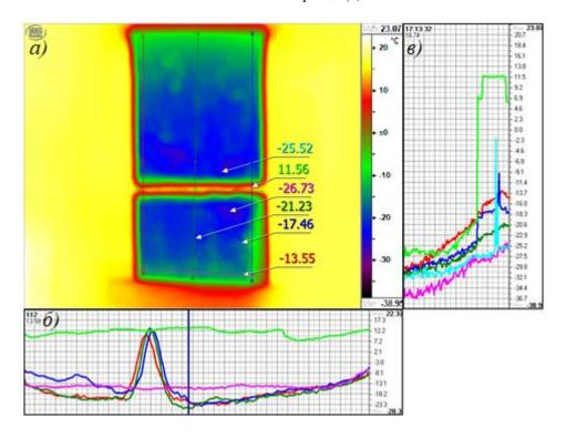
Рис. 15. Термограмма (кадр 123 из 128) деформирования охлажденного образца типа Б (a) и графики изменения температур поверхности по выделенным линиям  $(\delta)$  и точкам за время испытания образца (s)
