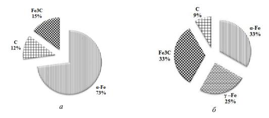
Рис. 3. Фазовый состав чугуна: (a) в исходном состоянии, (б) после лазерной закалки при режимах V = 100 мм/мин, d = 1 мм
