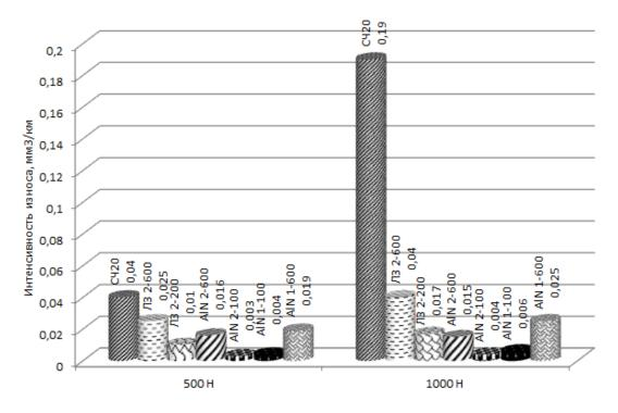
Рис. 5. Диаграмма значений интенсивности износа необработанного чугуна (СЧ20), чугуна после лазерной закалки (Л3) и после лазерного легирования (AlN)
