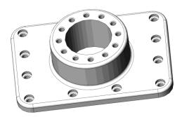
Рис. 1. Пример типовой детали при обработке осевым инструментом
