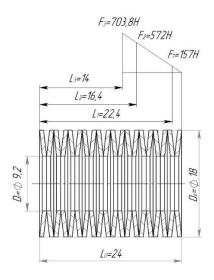
Рис. 4. Пакет № 2 тарельчатых пружин (малая пружина)
