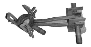
Рис. 1. Индуктор для установки индукционного нагрева
