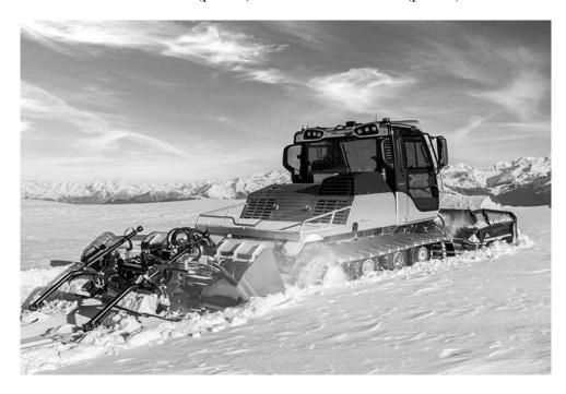
Рис. 7. PrinothHUSKY с двигателем MTU 4R 1000 OM 934  $170~{\rm kBt/231}~{\rm n.~c.}$
