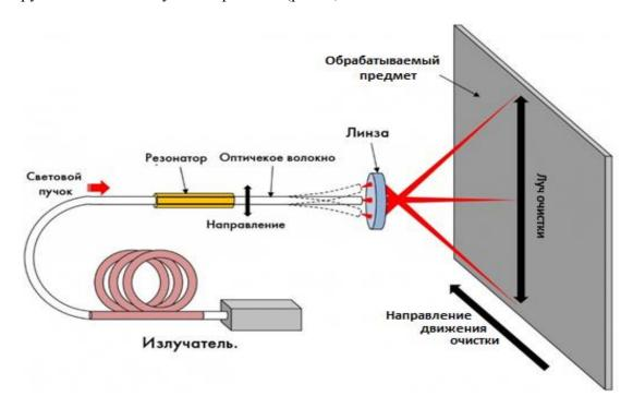
Рис. 1. Упрощенная схема экспериментальной системы лазерной очистки на основе импульсного оптоволоконного лазера
