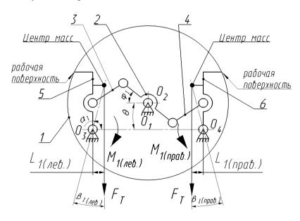
Рис. 5. Неуравновешенность встречно-расположенных рабочих органов в их нерабочем положении при произвольном положении шкива:
