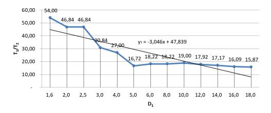
Рис. 5. График зависимости отношения временной стойкости ступеней КОИ  $T_1/T_2$  от диаметра  $D_1$  крепежного отверстия (линия тренда на графике:  $y_T = \frac{T_1}{T_2}$ ,  $x = D_1$ )
