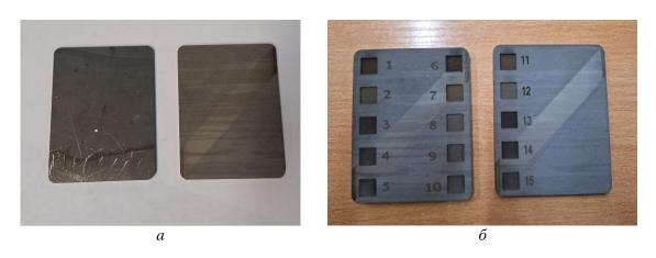
Рис. 2. Вид стальных пластинчатых образцов со слоем окалины до лазерной обработки (a) и после ее проведения на локальных участках  $(\delta)$
