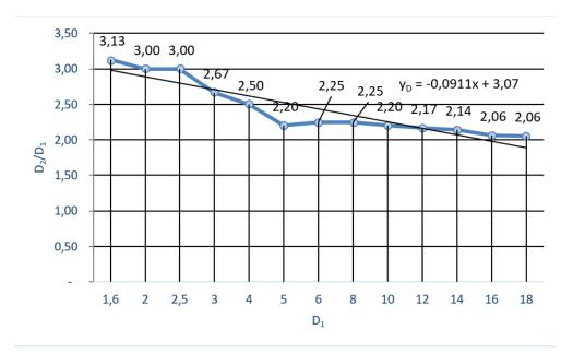
Рис. 3. Отношение диаметров ступеней КОИ от диаметра отверстия  $D_I$  с поднутрением (линия тренда на графике:  $y_D = \frac{D_2}{D_1}, \ x = D_1$ )
