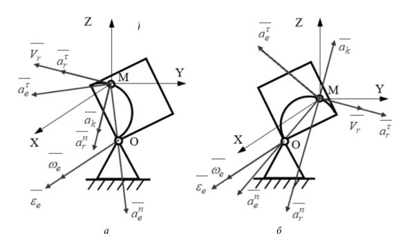
Рис. 6. Варианты схем синтеза КСДТ, построенных по критерию  $\overline{a} = \overline{a_r^{\tau}} + \overline{a_r^n} + \overline{a_e^{\tau}} + \overline{a_e^n} + \overline{a_e^n}$
