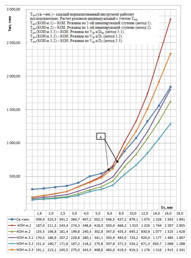
Рис. 9. Штучное время  $(T_{\text{шт}})$  при обработке отверстий с поднутрением при разных стратегиях управления процессом резания, на партию отверстий 1000 шт.
