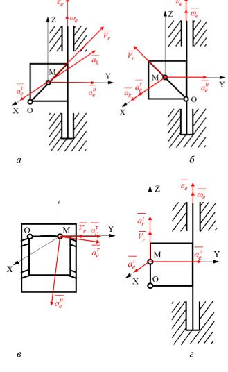
Рис. 4. Варианты схем синтеза КСДТ, построенных по критериям  $\overline{a} = \overline{a_e^\tau} + \overline{a_e^n} + \overline{a_k}$ ,  $\overline{a} = \overline{a_r^\tau} + \overline{a_e^\tau} + \overline{a_e^n}$
