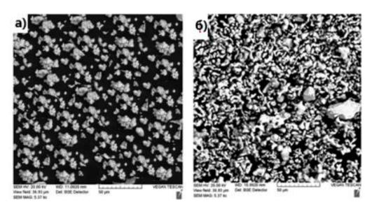
Рис. 2. Используемые твердые частицы: a — карбид вольфрама (WC);  $\delta$  — карбид хрома ( $Cr_3C_2$ )
