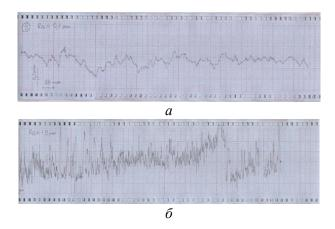
Рис. 8. Профилограмма поверхности образцов после термообработки: a – без оплавления поверхности;  $\delta$  – с оплавлением поверхности
