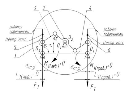
Рис. 7. Положение УКПС, когда одновременно каждая из сил тяжести, приложенная в центре масс соответствующего рабочего органа, проходит через точку его шарнирного закрепления:
