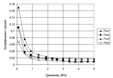
Рис. 5. Влияние давления на коэффициент трения псевдосплавов на снове каркаса из стали ЖГр0,5 с добавкой твердой смазки, инфильтрированного медно-оловянным сплавом: ряд 1-0 % добавки; ряд 2-0,5 %  $MoS_2$ ; ряд 3-0,8 % S; ряд 4-5 % Pb
