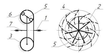
Рис. 1. Схема планетарной торовой винтовой передачи: I — ведущий вал; 2, 4 — беговые дорожки; 3 — зафиксированное звено; 5 — составной ролик; 6 — палец составного ролика; 7 — ведомый вал
