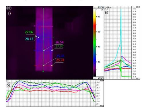
Рис. 3. Термограмма (кадр 10) деформирования образца 2 (a) и графики изменения температур поверхности по выделенным линиям ( $\delta$ ) и точкам за время испытания образца ( $\epsilon$ )
