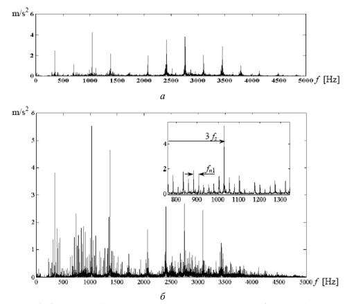
Рис. 2. Спектры вибраций исправной передачи (а) и с дефектом (б)
