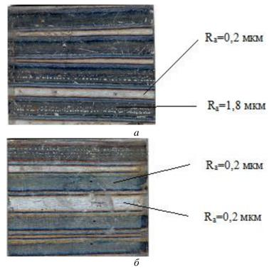
Рис. 4. Микрогеометрия поверхности образцов после термообработки: a-c оплавлением поверхности;  $\delta-$  без оплавления поверхности
