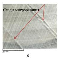
Рис. 2. Форма стружек (x250) (a) и следы микрорезания (x100) ( $\delta$ ) после MAO
