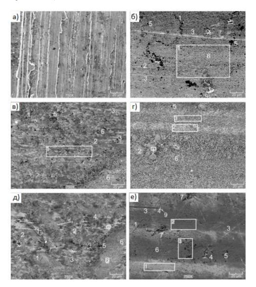
Рис. 6. Изображения поверхности после шлифования (a) и изношенных поверхностей, сформированных плазменным напылением ( $\delta$ ) и лазерным переплавом при различных параметрах лазерной обработки: s-100 мм/мин, 1 мм²; z-300 мм/мин, 1 мм²;  $\partial-100$  мм/мин, 3 мм²; e-300 мм/мин, 3 мм²
