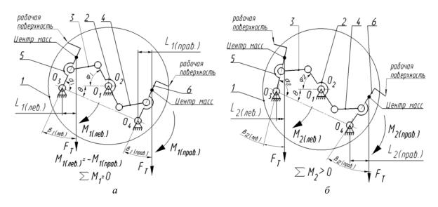
Рис. 8. Ограничитель с уравновешенными рабочими органами в их нерабочем положении при любом угловом положении УКПС и его разбалансировка при переходе рабочих органов в их рабочее положение:
