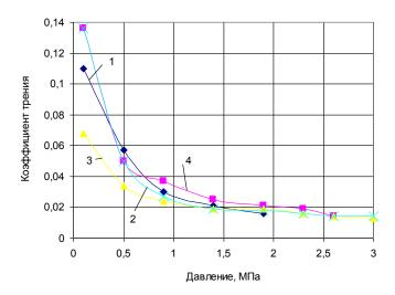
Рис. 3. Влияние давления и содержание углерода в каркасе на коэффициент трения псевдосплава, полученного инфильтрацией медным сплавом:
