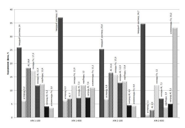
Рис. 4. Фазовый анализ после лазерного легирования нитридом алюминия при различных режимах обработки
