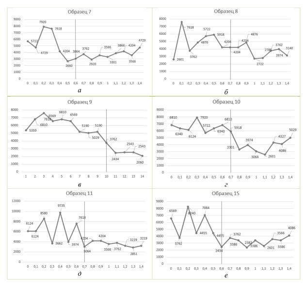
Рис. 7. Графики изменения твердости по глубине: a - e – режимы 7–11 и 15 соответственно
