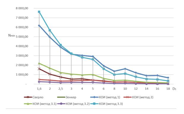
Рис. 7. Штучная наработка до отказа  $N_{min}$  нормализованными или КОИ в зависимости от диаметра  $D_1$  отверстия при разных стратегиях назначения режимов резания
