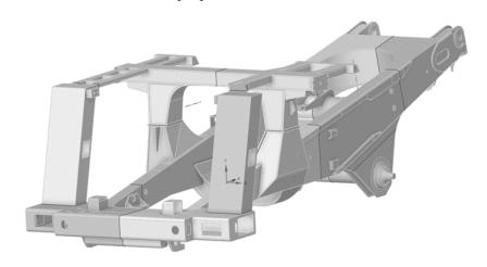
Рис. 3. Трехмерная геометрическая расчетная модель рамы карьерного самосвала
