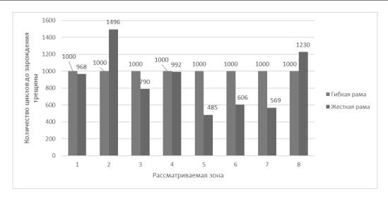
Рис. 12. Сравнение долговечности в циклах для подмоделей по методу VOLVO
