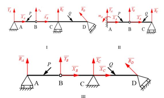
Рис. 4. Двухэлементные схемы
