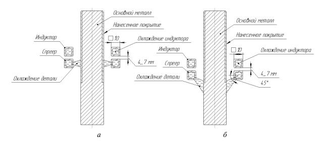
Рис. 3. Конструкция индукторов: a — на первоначальном этапе исследования;  $\delta$  — на текущем этапе исследования
