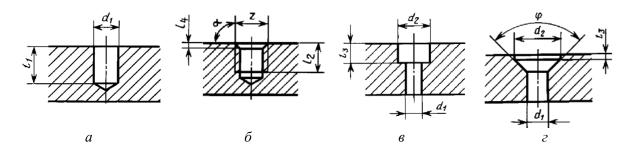
Рис. 1. Типы стандартизованных крепежных отверстий:
