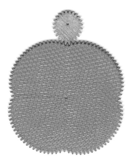
Рис. 4. Изготовленные пластиковые прототипы некруглых зубчатых колес
