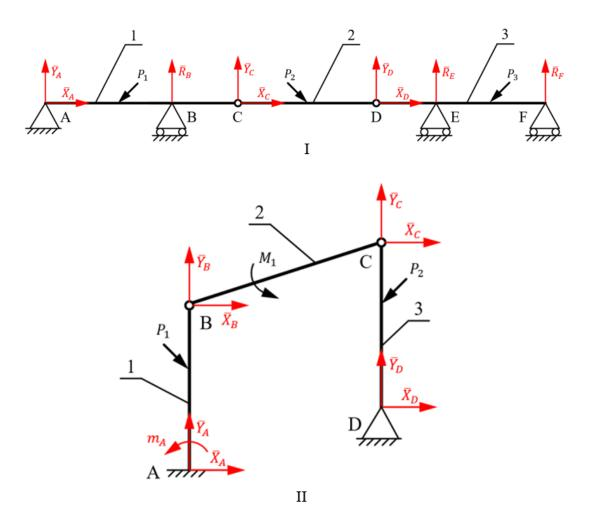
Рис. 8. Трехэлементные схемы: I – «Мост»; II – «Ферма»
