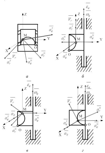
Рис. 5. Варианты схем синтеза КСДТ, построенных по критериям  $\overline{a} = \overline{a_r^\tau} + \overline{a_r^n} + \overline{a_e^\tau} + \overline{a_e^\tau} + \overline{a_e^n}$ ,  $\overline{a} = \overline{a_r^n} + \overline{a_e^\tau} + \overline{a_e^n} + \overline{a_e^\tau}$
