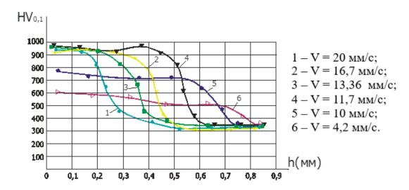
Рис. 5. Зависимости распределения микротвердости стали 45 по глубине поверхностного слоя
