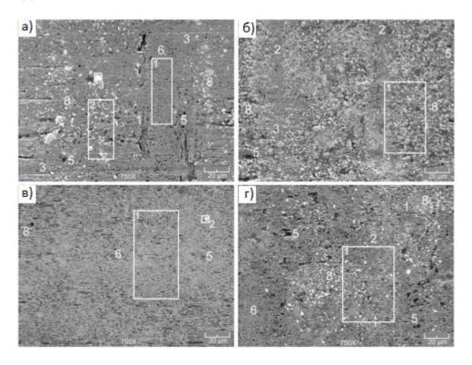
Рис. 7. Изображения изношенных поверхностей, образованных лазерным легированием карбидами вольфрама (WC) при различных параметрах лазерной обработки:  $a-100 \text{ мм/мин}, 1 \text{ мм}^2; 6-300 \text{ мм/мин}, \text{SLS } 1 \text{ мм}^2; 6-100 \text{ мм/мин}, 3 \text{ мм}^2; 2-300 \text{ мм/мин}, 3 \text{ мм}^2$
