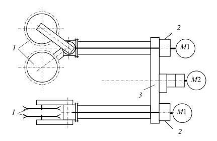
Рис. 2. Схема привода сдвоенного планетарно-дискового исполнительного органа проходческо-очистного комбайна:
