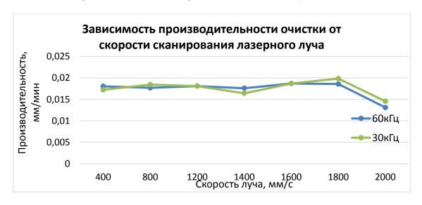
Рис. 3. Экспериментальная зависимость производительности очистки от линейной скорости сканирования лазерного луча
