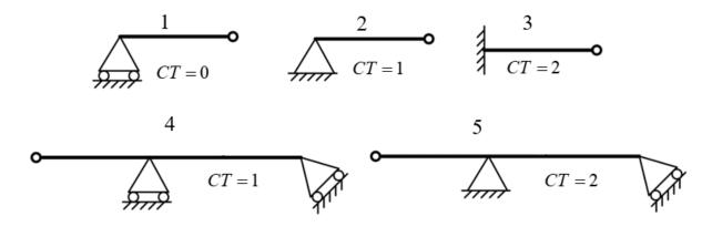
Рис. 3. Конструктивные единицы для синтеза двухэлементных схем
