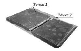
Рис. 10. Вид излома образца типа Б
