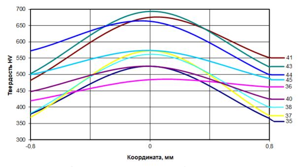
Рис. 6. Зависимости микротвердости стали 45 по ширине дорожки
