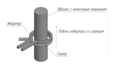
Рис. 2. Принцип действия оплавления ТВЧ в режиме закалки
