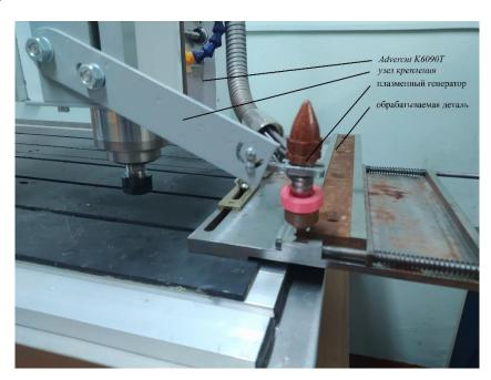
Рис. 1. Фрагмент экспериментальной установки для поверхностного плазменного упрочнения стальных изделий
