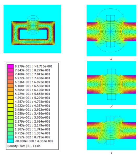
Рис. 1. Топография МП в рабочем зазоре при МАО наружных сферических поверхностей: a – плоский;  $\delta$  – эквидистантный;  $\epsilon$  – серповидный
