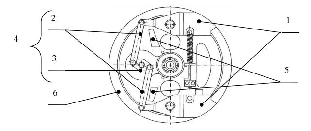
Рис. 1. Ограничитель скорости фирмы «Dynatech»: I — рабочие органы УКПС; 2 — шатуны; 3 —коромысло; 4 — механизм синхронизации; 5 — опоры; 6 — шкив
