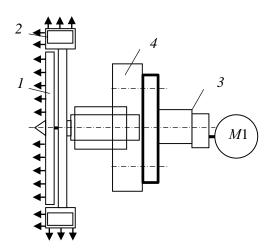
Рис. 5. Схема одномоторного привода соосных роторов: 1 — центральный ротор; 2 — крестовина с ковшами; 3 — первая ступень привода; 4 — распределительный редуктор второй ступени привода
