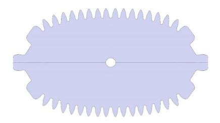
Рис. 8. Визуализация модели симметричного ведущего колеса со сдвоенными зубьями
