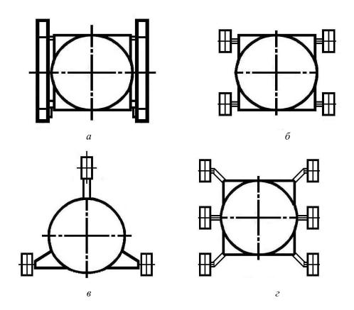
Рис. 5. Конструктивные схемы колесно-шагающих ходовых систем для беспилотных наземных аппаратов различного назначения:
