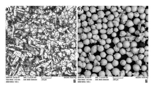
Рис. 1. Микроструктура исследуемой бронзы (a) и частицы в исходном состоянии  $(\delta)$
