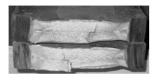
Рис. 9. Вид излома образца типа А
