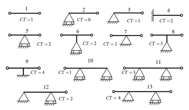
Рис. 5. Конструктивные единицы для синтеза трехэлементных схем
