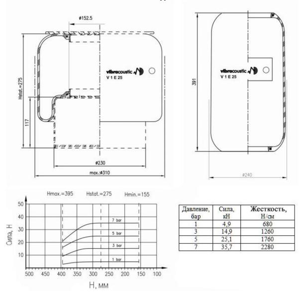
Рис. 1. Характеристики пневмобаллона [9]
