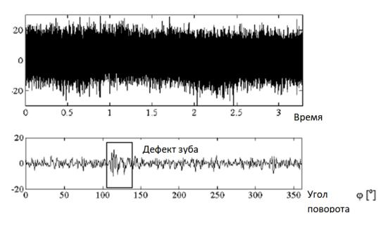
Рис. 3. Вибрационный сигнал во временном базисе и при синхронном измерении в зависимости от угла поворота вала
