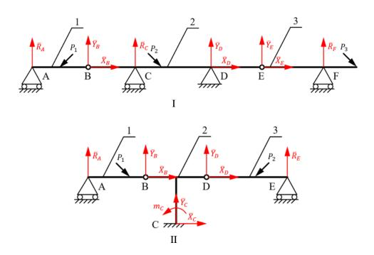
Рис. 6. Трехэлементные схемы: I – «Мост»; II – «Ферма»
