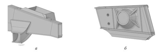
Рис. 8. Геометрия подмодели: a — первая подмодель;  $\delta$  — вторая подмодель (другим цветом указаны смоделированные сварные швы согласно картам сварных соединений)
