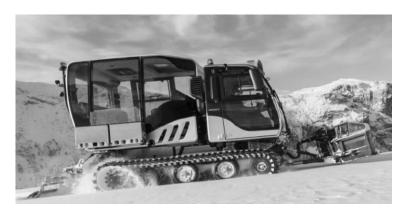
Рис. 1. Ратрак с установленной кабиной для перевозки людей
