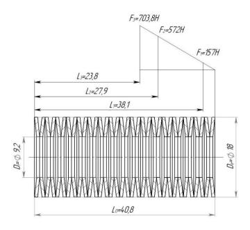
Рис. 3. Пакет № 1 тарельчатых пружин (большая пружина)
