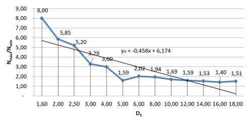
Рис. 6. График зависимости отношения количества обработанных отверстий ступенями КОИ  $N_{max}/N_{min}$  за время наработки на отказ от диаметра  $D_I$  крепежного отверстия (линия тренда на
