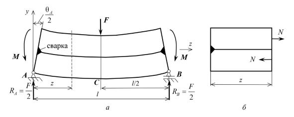
Рис. 2. Изгиб двухопорной балки, составленной из скрепленных между собой стержней: a – схема нагружения и деформации;  $\delta$  – схема действия внутренних сил
