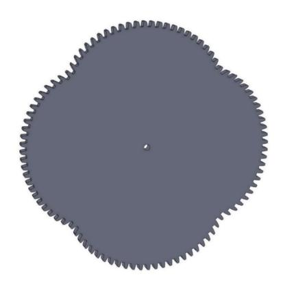
Рис. 2. Трехмерная визуализация модели ведомого колеса
