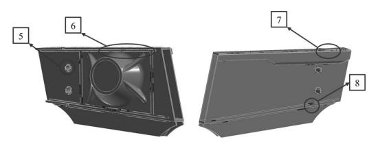
Рис. 11. Принятые для сравнения зоны с минимальной долговечностью, вторая подмодель
