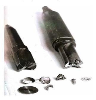
Рис. 1. Общей вид безперемычных сверл с МНП  $\varnothing$  25 мм
