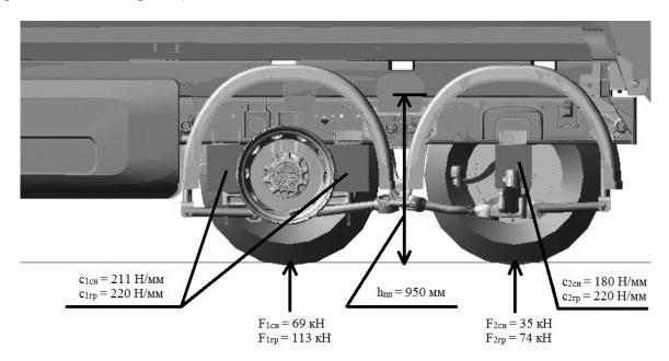
Рис. 3. Расчетная схема статического анализа подвески
