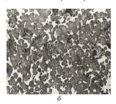
Рис. 2. Микроструктура псевдосплава ЖГр1Д25, полученного различным способом: a – прессование и спекание, не травлено;  $\delta$  – инфильтрация, травлено. X350
