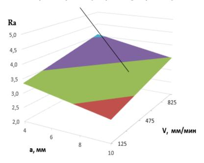
Рис. 2. Поверхность отклика влияния амплитуды и скорости на шероховатость при ширине луча 3,0 мм
