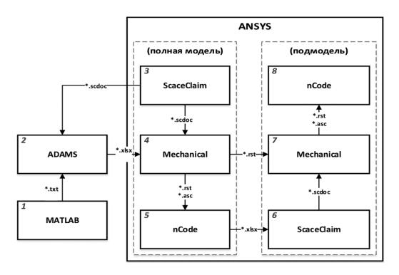
Рис. 1. Алгоритм проведения виртуальных испытаний
