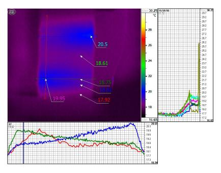
Рис. 11. Термограмма (кадр 87) деформирования образца типа Б за секунду до излома (a) и графики изменения температур поверхности по выделенным линиям  $(\delta)$  и точкам за время испытания образца (s)
