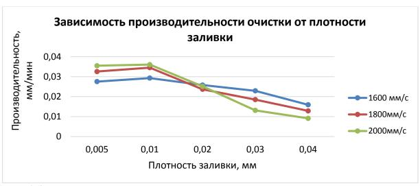
Рис. 4. Экспериментальная зависимость производительности очистки от «плотности заливки» при сканировании
