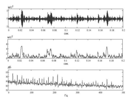
Рис. 2. Форма сигнала вибрации на выходе широкополосного фильтра (первый график), форма ее огибающей (второй график) и спектр огибающей (третий график)
