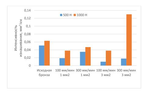
Рис. 5. Значения скорости изнашивания бронзы, напыленной плазмой и переплавленной лазером, при нагрузках 500 и 1000 H
