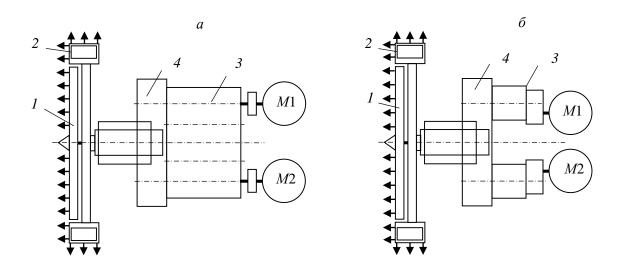
Рис. 1. Схемы двухмоторных приводов соосных роторов проходческих комбайнов:  $a-\Pi KC$ -8;  $\delta-KP\Pi$ -3 [5]; 1 и 2 – центральный и внешний роторы; 3 и 4 – редукторы привода
