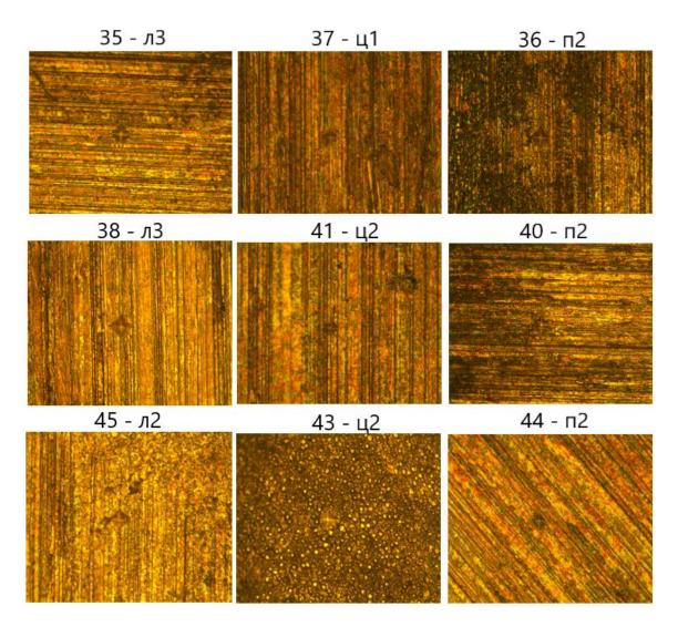
Рис. 7. Микроструктура поверхности упрочненной зоны
