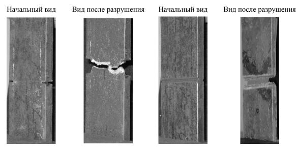
Рис. 6. Вид пластин с боковыми симметричными надрезами
