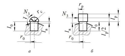
Рис. 2. Схема установки пальца в составном ролике и действующих на него сил: a — со сферической формой наружной поверхности пальца;  $\delta$  — с цилиндрической формой наружной поверхности пальца
