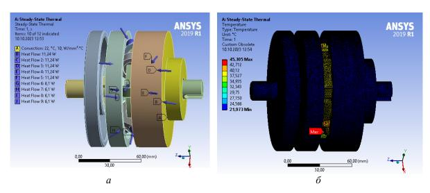
Рис. 4. Тепловой анализ исследуемой передачи (корпус не показан): a – граничные условия;  $\delta$  – результаты расчета температурного состояния
