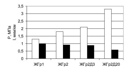
Рис. 4. Влияние содержания меди на предельное давление схватывания и интенсивность изнашивания (при  $P=2.8~\mathrm{MHa},~V=4~\mathrm{m/c}$ ) псевдосплава, получаемого прессованием и спеканием:
