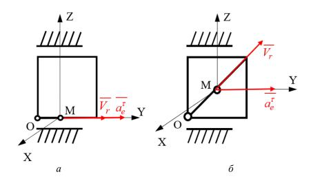
Рис. 2. Варианты схем синтеза КСДТ, построенных по критерию  $\overline{a}=a_e^{ au}$
