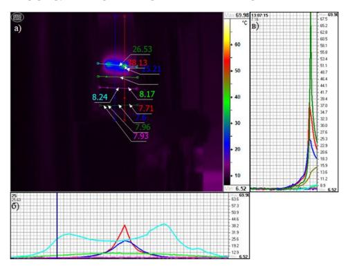
Рис. 8. Термограмма (кадр 48) деформирования образца при образовании шейки (a) и графики изменения температур поверхности по выделенным линиям  $(\delta)$  и точкам за время испытания образца  $(\epsilon)$
