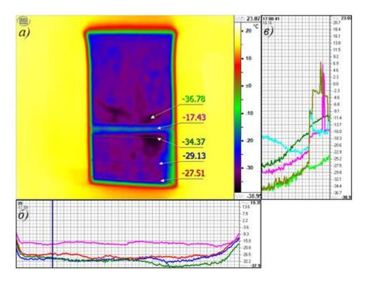
Рис. 14. Термограмма (кадр 1 из 128) деформирования охлажденного образца типа Б (a) и графики изменения температур поверхности по выделенным линиям  $(\delta)$  и точкам за время испытания образца (s)
