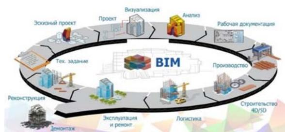
Рис. 4. Жизненный цикл сооружения
