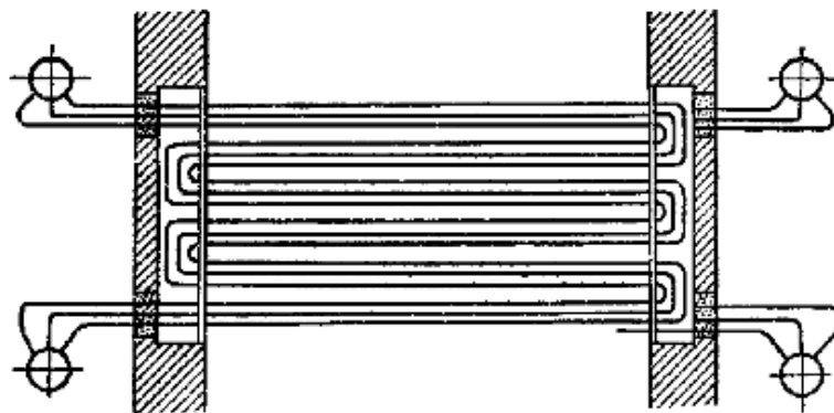
Рисунок 5.64 – Схема расположения змеевиков в экономайзере
