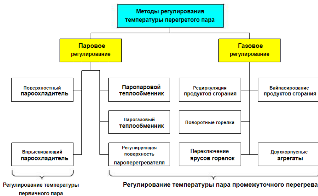
Рисунок. 5.44 – Классификация методов регулирования температуры пара высокого давления и пара промежуточного перегрева
