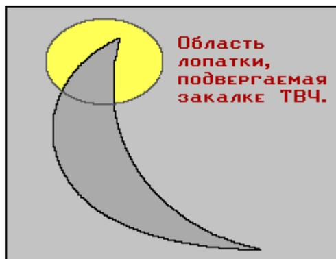
Рис. 4.15 Область лопатки подвергаемая закалке ТВЧ
