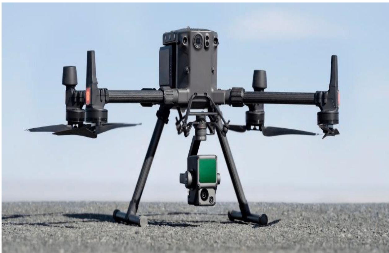
Рисунок 1 – Беспилотный комплекс для лазерного сканирования автомобильных дорог DJI Matrice 300 RTK
