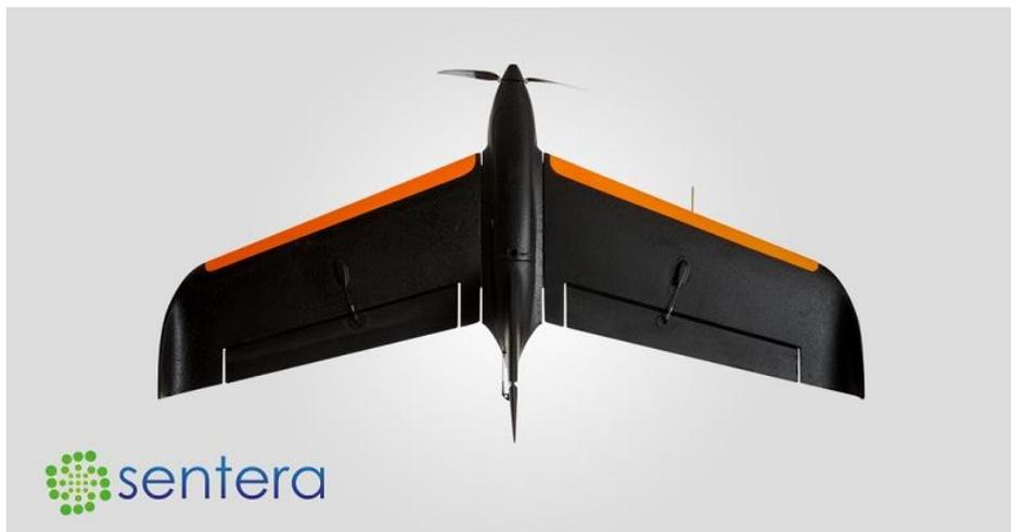
Рисунок 2 – Беспилотник с неподвижным крылом Phoenix 2 компании Sentera
