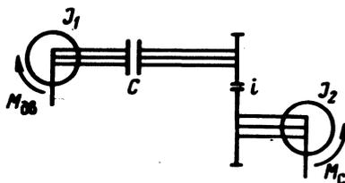
Рис. 1. Динамическая система машинного агрегата автомобиля.
