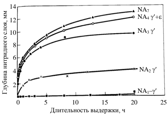
Рис. 4. Влияние насыщающей способности среды на образование слоя соединений на стали 42CrMo4 (отечественный аналог – 38ХМ)
