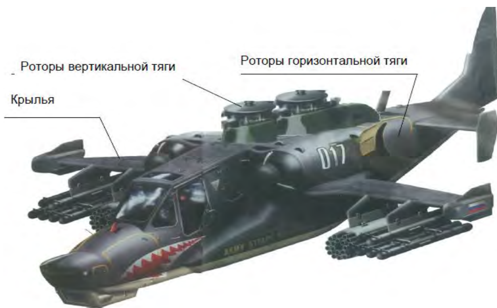
Рисунок 5. – Эскизный проект модернизации вертолета
