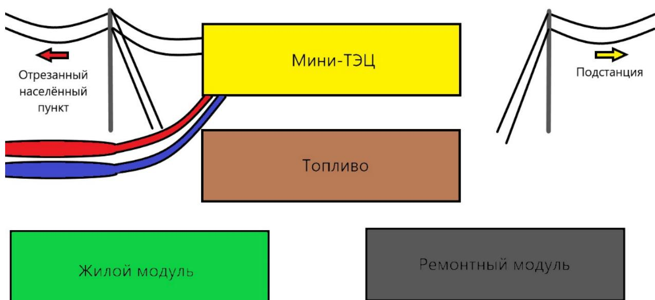
Рисунок 4 – Полная схема мини-ТЭЦ для чрезвычайных ситуаций
