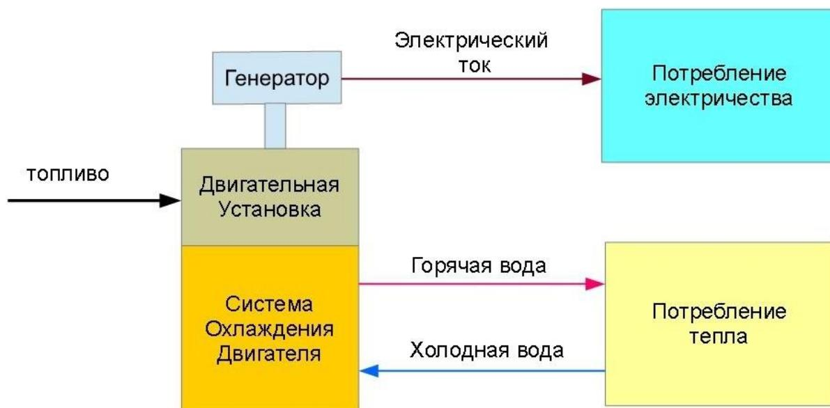
Рисунок 1 – Схема когенерации
