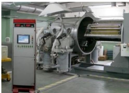
Рис. 1. Вакуумная установка модели «Рулон–1000»
