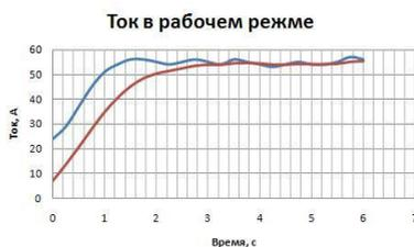
Рис. 4. Ток при нормальной работе компрессора
