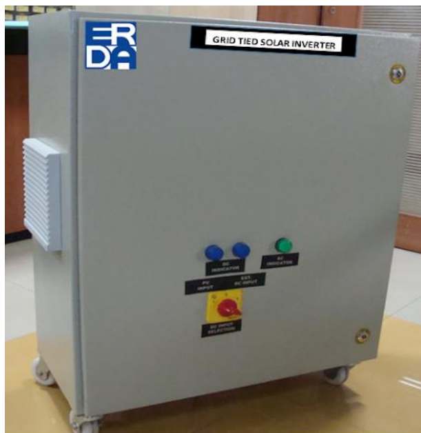
Рисунок 8 – Солнечный инвертор с компенсацией реактивной мощности (5 кВА)
