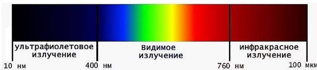
Рисунок 1— Спектр оптического излучения
