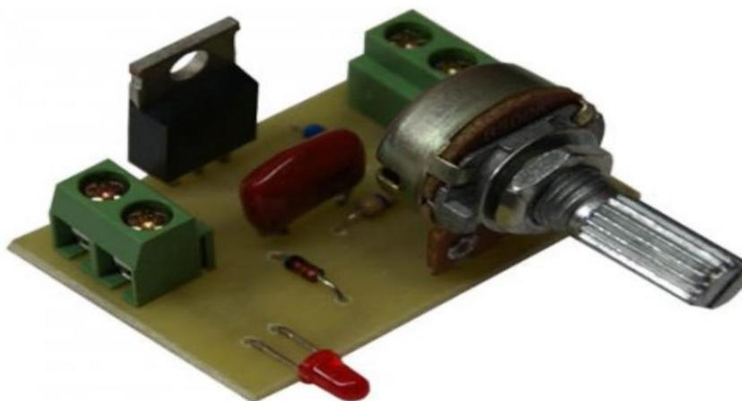
Рисунок 1 - Внешний вид простейшего регулятора мощности на симисторе
