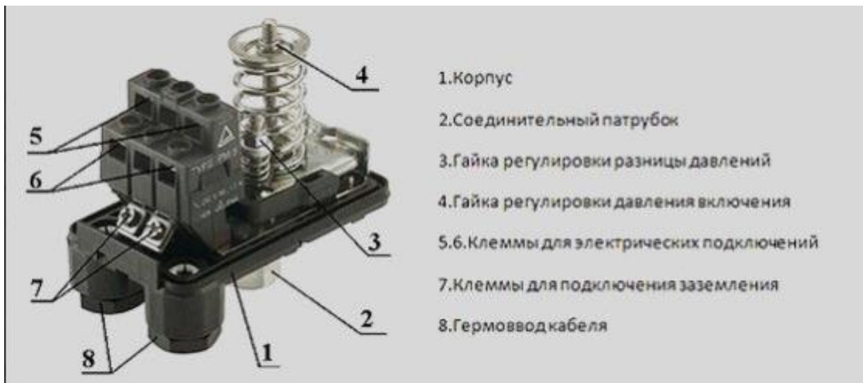
Рисунок 4. – Устройство типового датчика
