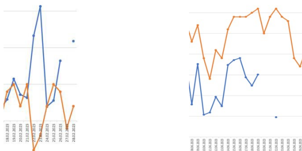
Рисунок 5. – Фрагменты графиков суточной выработки и среднесуточной температуры окружающего воздуха для фотовольтаической станции Chaplin 1: слева - диапазон от 18.02.2023-28.02.2023г.; справа - диапазон от 08.06.2023 – 26.06.2023 г..
