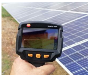
Рисунок 7. – Измерение температурных параметритов солнечной панели
