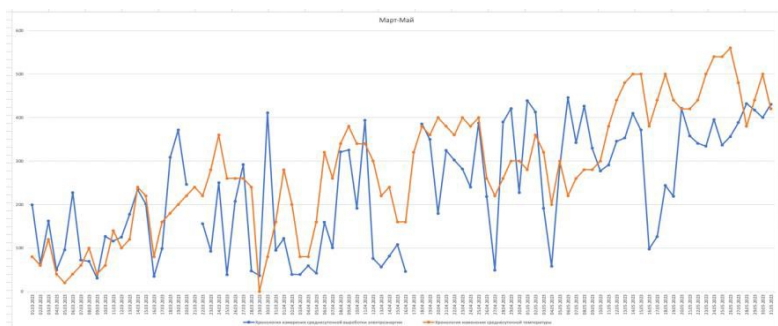
Рисунок 3. – Хронология изменения в течение марта 2023г. – мая 2023 г.суточной выработки фотовольтаической станцией Charlin 1 и среднесуточной температуры окружающего воздуха в районе размещения фотовольтаической станции.
