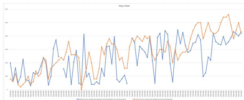
Рисунок 3. – Хронология изменения в течение марта 2023г. – мая 2023 г.суточной выработки фотовольтаической станцией Charlin 1 и среднесуточной температуры окружающего воздуха в районе размещения фотовольтаической станции.
