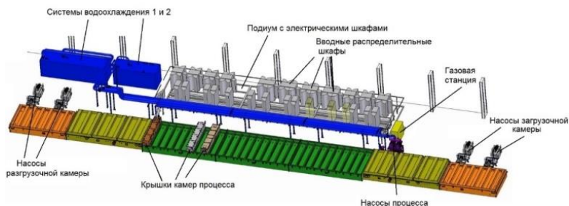
Рисунок 1 - Магнетронный коатер BUHLER Leybold Optics Apollon 3300
