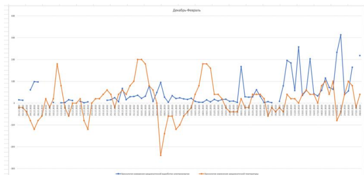
Рисунок 2. – Хронология изменения в течение декабря 2022г. - февраля 2023 г.суточной выработки фотовольтаической станцией Chaplin 1 и среднесуточной температуры окружающего воздуха в районе размещения фотовольтаической станции.
