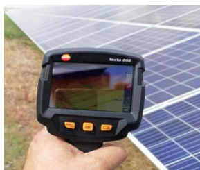
Рисунок 7. – Измерение температурных параметров солнечной панели
