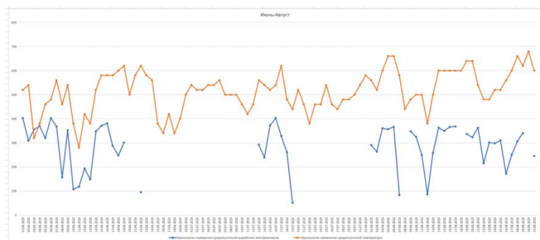
Рисунок 4. – Хронология изменения в диапазоне июнь 2023г. – август 2023 г.суточной выработки фотовольтаической станцией Charlin 1 и среднесуточной температуры окружающего воздуха в районе размещения фотовольтаической станции.
