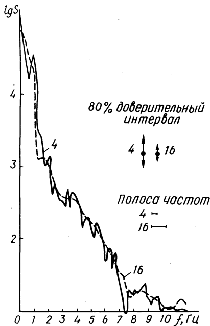
Рис. 1. Две оценки спектральной плотности одной и той же реализации с окнами Тьюки разной ширины ( \tau/m=4 ; \tau/m=16 ). Крутящий момент на полуоси колесного трактора МТЗ-3Э80 (гидротрансформатор заблокирован) при пахоте.
