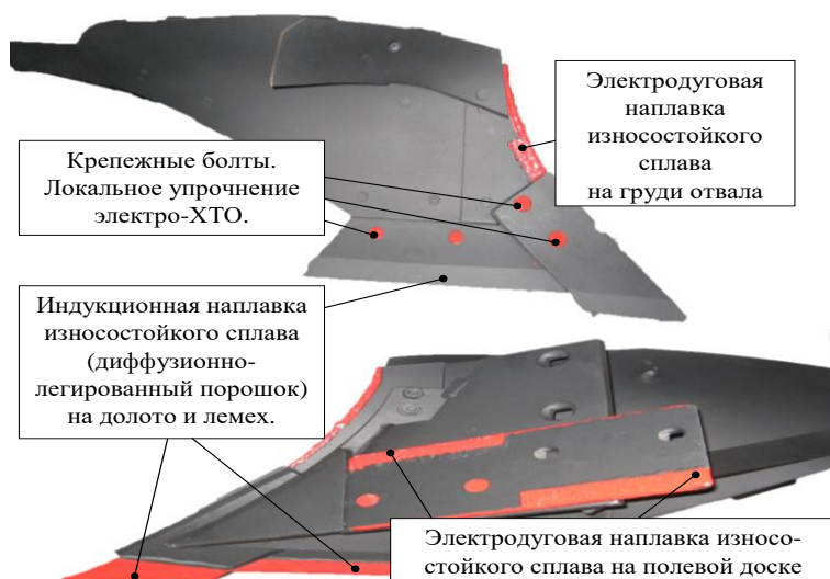
Рисунок 5 – Корпус плуга Минского завода шестерен с упрочненными быстроизнашиваемыми деталями
