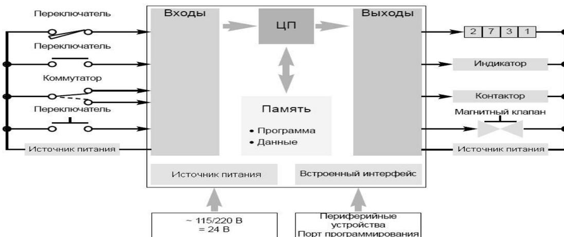
Рисунок 2 – Функциональная схема СУ на базе ПЛК
