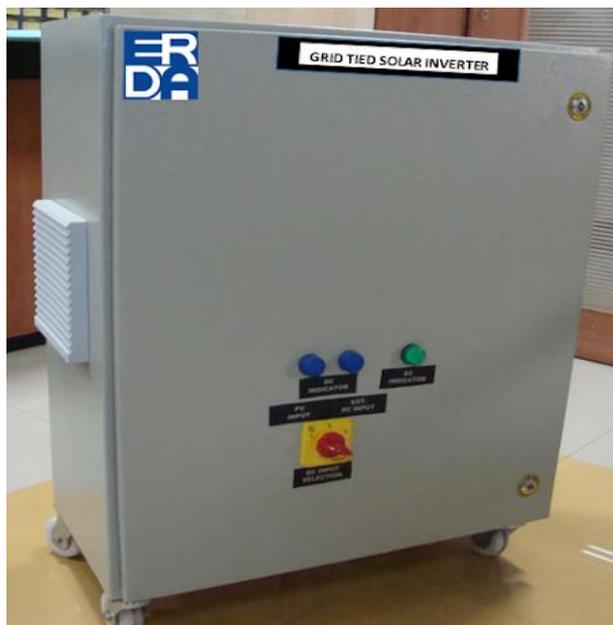
Рисунок 8 – Солнечный инвертор с компенсацией реактивной мощности (5 кВА)
