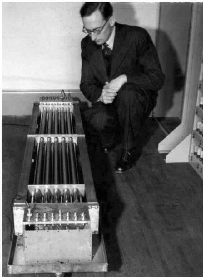
Рисунок 1 — Уилкс с батареей ртутных трубок
