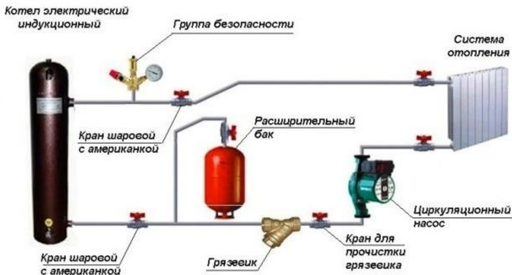
Рисунок 3 – Схема установки электрического котла для домашнего отопления [2]
