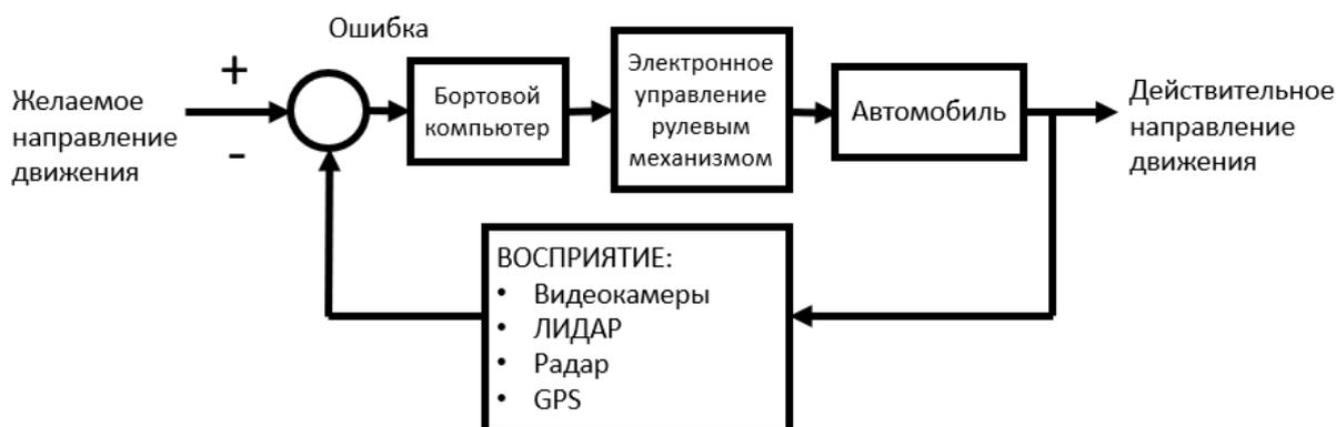
Рисунок 6 – Система управления беспилотным автомобилем с помощью электронного управления рулевым механизмом
