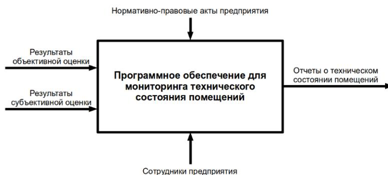
Рисунок 2 – Контекстная диаграмма программного обеспечения
