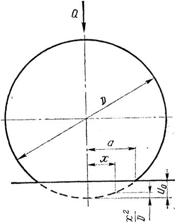
Рис. 1. Схема деформации пневматической шины на жестком основании.
