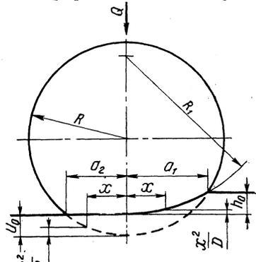
Рис. 3. Схема взаимодействия пневматической шины с почвой при качении колеса.
