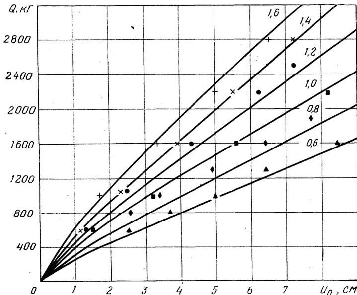
Рис. 5. Зависимость между нагрузкой и деформацией шины 12-38 на мягкой почве (при различных  $p$ ,  $\text{кг/см}^2$ ).
