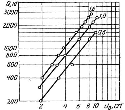
Рис. 2. Нагрузочная характеристика шины 12-38 в логарифмических координатах (при различных  $p$  кг/см<sup>2</sup>).
