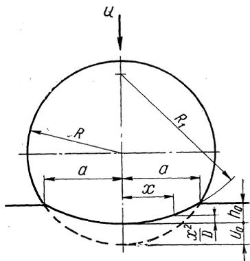
Рис. 4. Схема взаимодействия пневматической шины с почвой при вдавливании в почву неподвижного колеса.
