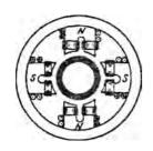
приведена схема возбуждения слоя магнитной жидкости вращающимся полем, создаваемым статором электродвигателя (тангенциальная ориентация). Рабочий объем установки определялся следующими размерами: диаметр до 22 мм и высота до 30 мм. В данном объеме вращающееся магнитное поле характеризуется высокой однородностью.
