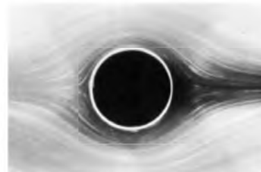
Фото 1. Обтекание кругового цилиндра однородным потоком при Re = 0,16 . Поток движется слева направо. Для визуализации течения воды применен алюминиевый порошок
