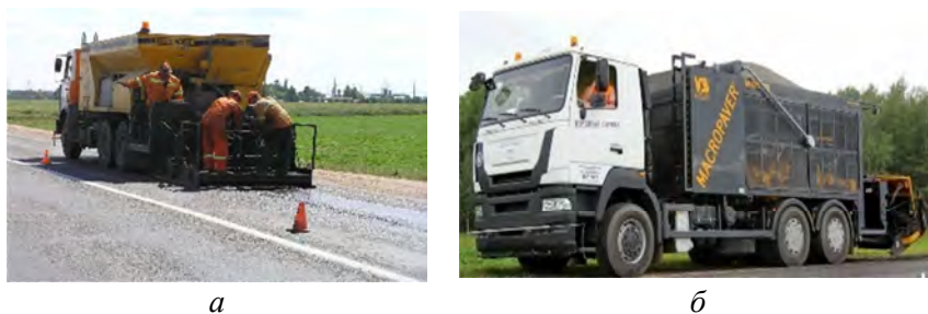
Рис. 7.24. Примеры смесителей укладчиков для устройства защитных слоев из холодных литых асфальтобетонных смесей:
