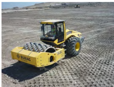
Рис. 7.10. Кулачковый дорожный каток Bomag BW 213-D5
