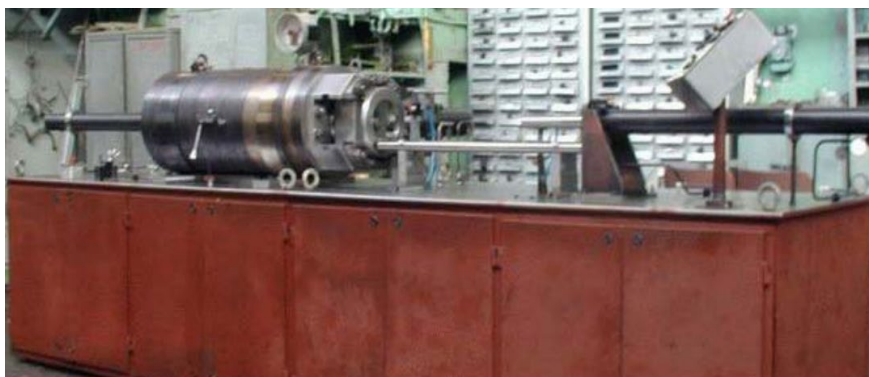
Рис. 3.10. Общий вид установки для сухого изостатического (радиального) прессования
