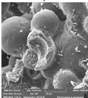
Рис. 4.36. Морфология поверхности образца 24 (микросферы + базальтовое волокно + алюмосиликат + порообразователь).
