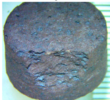
Рис. 3.13. Общий вид ( a, b, d ) и морфология излома ( б, z, e ) образцов 4–6 состава: базальтовое волокно + 15 % \text{Fe}_2\text{O}_3
