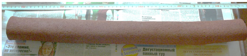
Рис. 3.11. Трубчатая заготовка, сформованная из базальтового волокна
