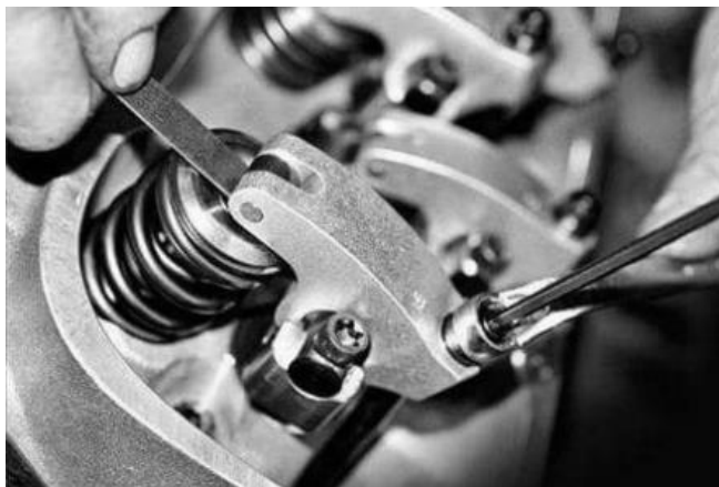
Рисунок 10.11 – Регулировка зазора в клапанах ГРМ винтом
