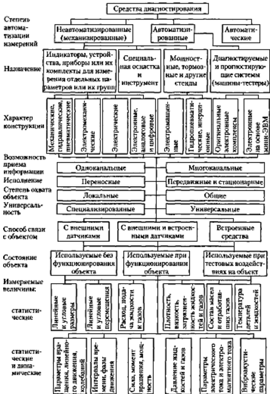
Рисунок 6 – Классификация средств диагностирования
