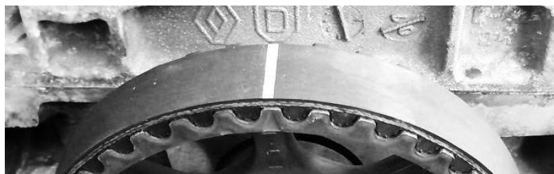
Рисунок 10.7 – Метки на цепи и ремне ГРМ и соответствующие им метки на звездочках и шкиве
