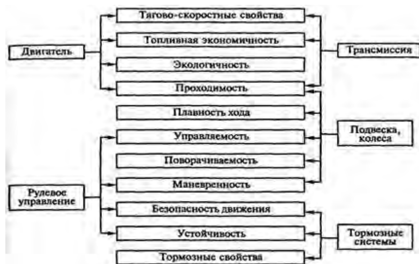
Рисунок 1 – Связь эксплуатационных свойств с системами и механизмами автомобиля
