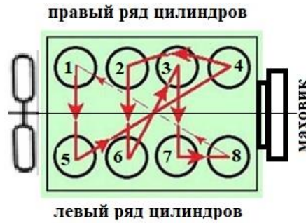
Рисунок 3.48. – Порядок работы цилиндров V8-образного двигателя
