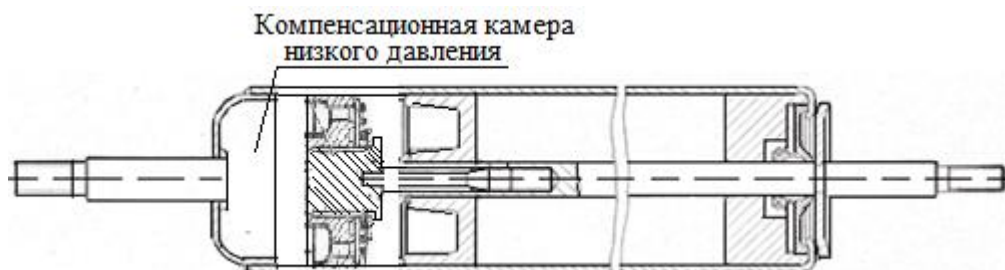
Рисунок 4.31. – Предлагаемая конструкция регулируемого амортизатора для сиденья
