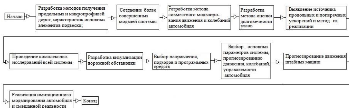
Рисунок 3.1. – Методика моделирования динамической системы “дорога–автомобиль–водитель”
