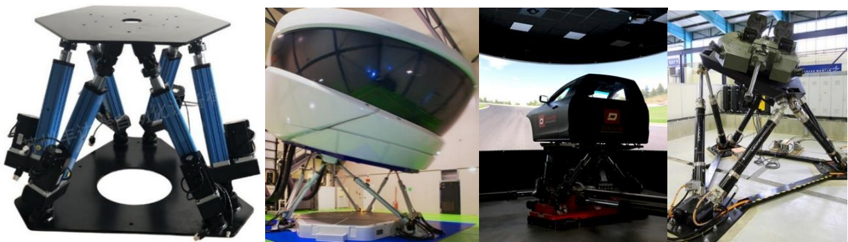
Рисунок 7.9. – Конструкция платформы, симуляторы самолета, автомобиля, танка
