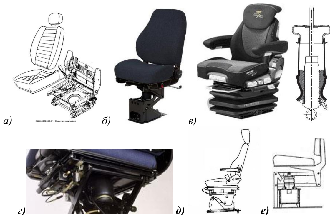
a – подрессоренное сиденье Viking-300; в, г – сиденья с ножнично-рычажной пневмоподвеской с рукавным элементом; б, д, е – с четырехрычажной схемой подвески
