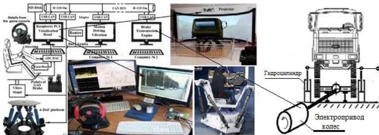
Рисунок В.7. – Предлагаемая схема имитационного моделирования автомобиля со стендом и смешанной реальностью
