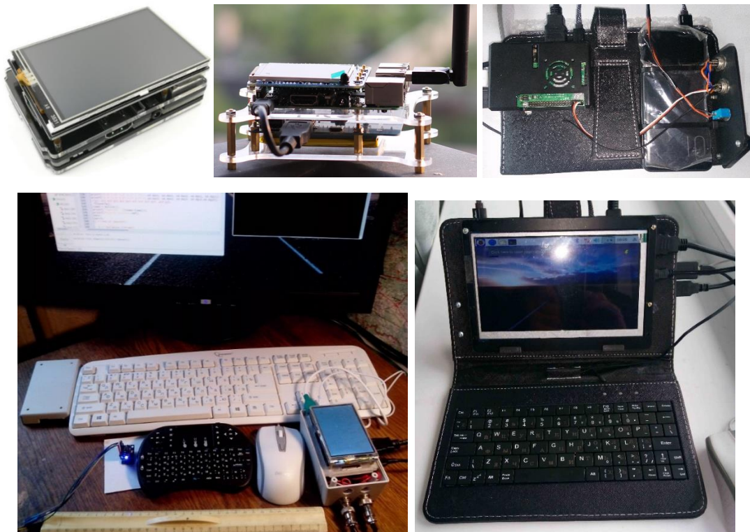
Рисунок 4.1– Общий вид собранных автором мини-компьютеров на базе Raspberry Pi 3
