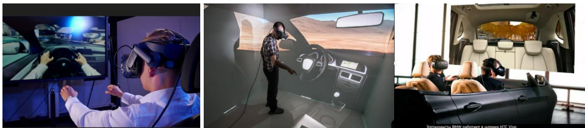
Рисунок В.5. – Использование смешанной реальности для исследований и проработки эргономики автомобиля
