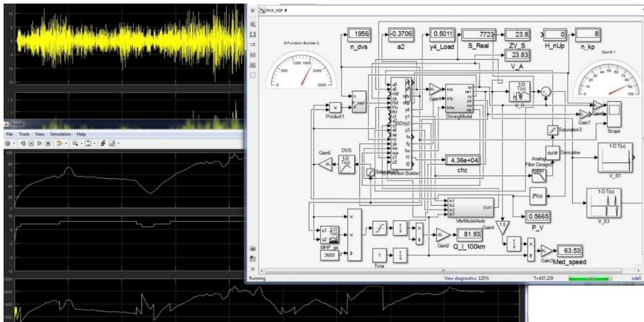
Рисунок 3.60. – Процесс и блок-схема моделирования движения, колебаний и управляемости автомобиля
