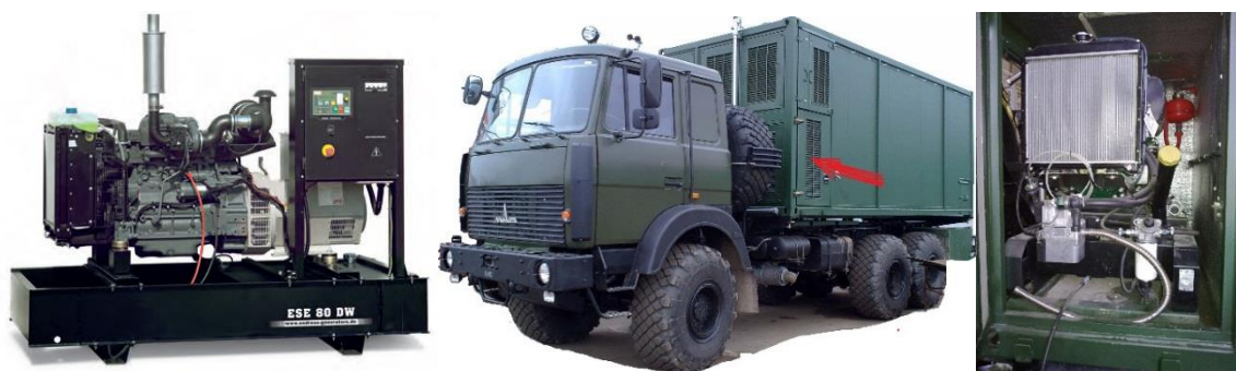
Рисунок 3.26. – Общий вид дизель-генераторной установки, компоновка ее в кузове-контейнере штабной машины
