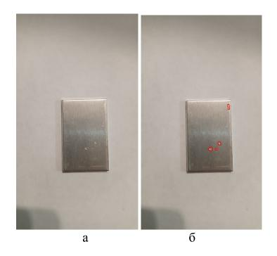
Рисунок 1 – Отштампованное изделие (a) и распознавание дефектов на его поверхности (б)
