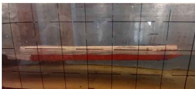
Рисунок 5– Модель несамоходного судна в гидродинамическом лотке (вид сбоку)
