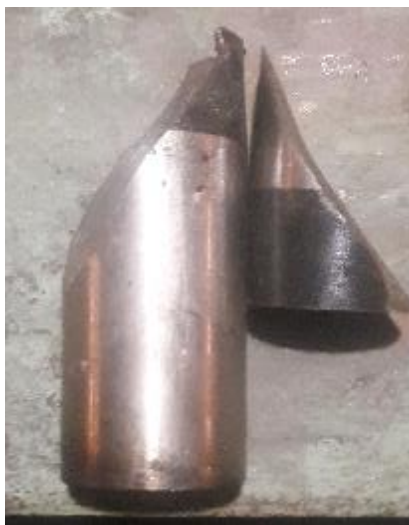
Рисунок 2 – Характер разрушение промежуточного бойка
