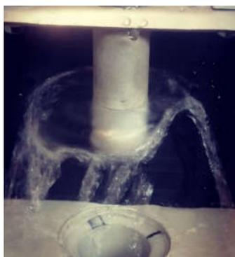
Рисунок 2 – Струя электролита, формируемая на выходе из электрода-инструмента
