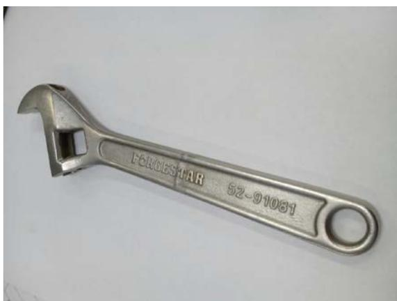
Рисунок 1 – Результат электрохимического полирования изделия из конструкционной легированной стали 40ХФА электролите на основе органического растворителя
