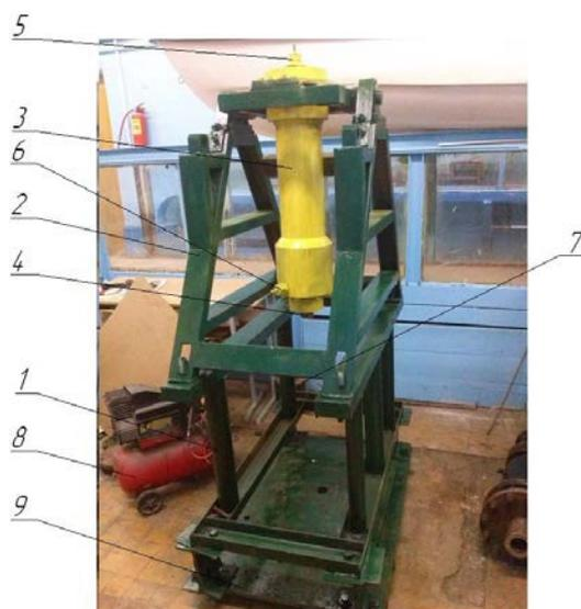
1 – рама; 2 – корпус; 3 – энергоузел; 4 – шток; 5 – ниппель для закачки энергоносителя в бесштоковую полость; 6 – ниппель для закачки энергоносителя в штоковую полость; 7 – матрица-держатель; 8 – компрессор; 9 – основание
