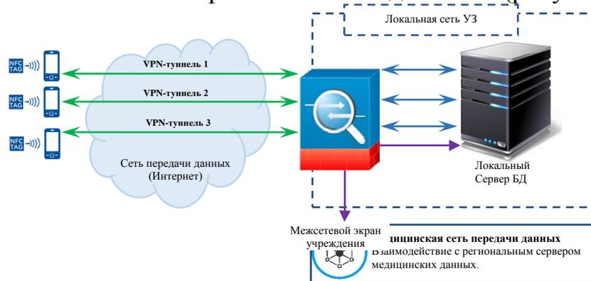
Рисунок 1. Схема организации работы с базой данных МИС с использованием бесконтактных меток.
