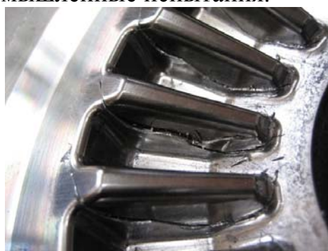
Рисунок 3 – Вид разрушения формообразующих зубьев матрицы
