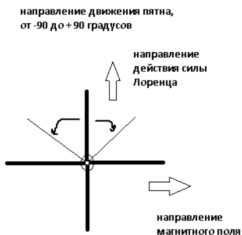
Рисунок - 1 расчетная схема. Поверхность эрозии лежит в плоскости рисунка
