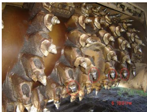
Рисунок 2 – Фрагмент барабана дорожной фрезы с резцами фирмы «Wirtgen» и опытными образцами, полученными методом СГВ
