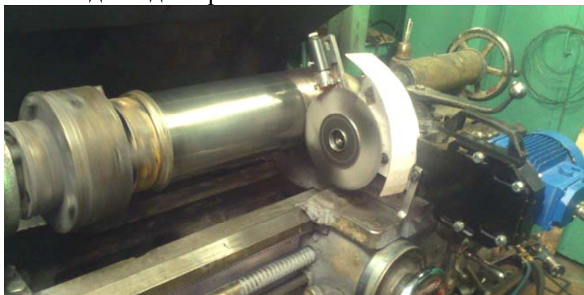
Рисунок 2 – Внешний вид установки для нанесения покрытий на наружные цилиндрические поверхности методом ПГИ
