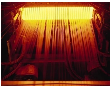
Рисунок 1 – Внешний вид подфильерного медного холодильника стекольного производства ламельной конструкции (а) и его работа в составе установки (б)
