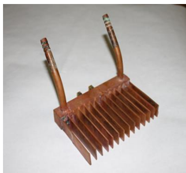
Рисунок 1 – Внешний вид подфильерного медного холодильника стекольного производства ламельной конструкции (а) и его работа в составе установки (б)
