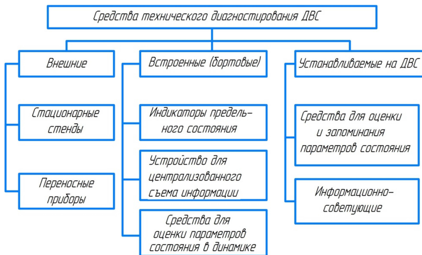
Рис. 5.2. Классификация средств технического диагностирования ДВС
